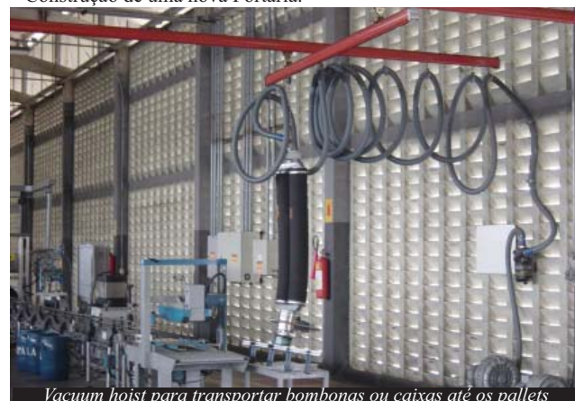
Vacuum hoist para transportar bombonas ou caixas até os pallets
